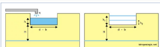
Fig. 1 – A sinistra: prova di permeabilità in pozzetto a carico costante; a destra: prova di permeabilità in pozzetto a carico variabile.
