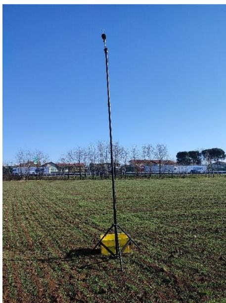
Le misure e le analisi sono state eseguite seguendo le prescrizioni del D.M. del 16 marzo 1998 "Tecniche di rilevamento e di misurazione dell'inquinamento acustico", in assenza di precipitazioni atmosferiche, vento e/o nebbia.
